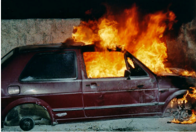
Das Feuer ist vom Motorraum aus auf den vorderen Teil des Fahrzeuginnen vorgedrungen.
