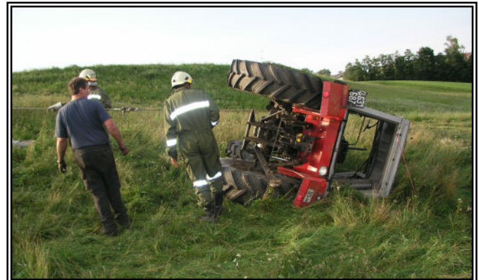
Vorsichtiges Straffen des Bergeseiles, um mit dem Aufstellen des Traktors zu beginnen.
