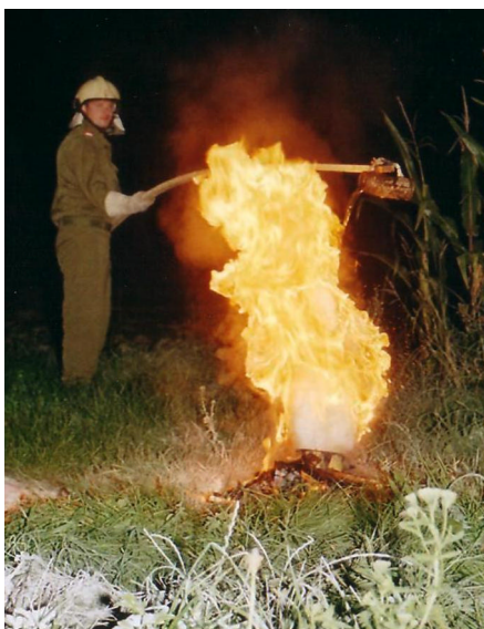
Demo: Fettbrand in einem Topf, wobei hier versucht wird den Brand mit Wasser zu löschen (katastrophaler Fehler).
