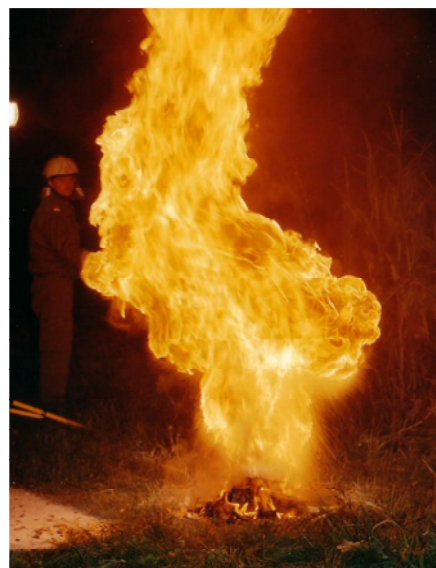
Folgewirkung: Es entsteht eine gewaltige explosionsartige Stichflamme mit verheerender Auswirkung (z.B.: Fettbrand in der Küche).
