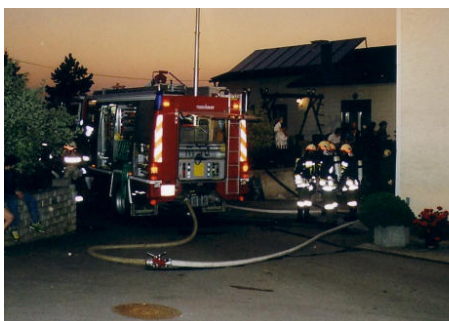
Löschwasserversorgung vom Tankwagen Sand für die Angriffstruppe zum Löschen der Brandherde.
