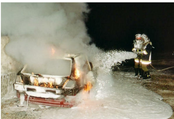
Das Fahrzeug mit Schaum zu löschen, ist wie hier zu sehen ist, der beste und schnellste Weg um Erfolg beim Löschen eines Fahrzeugbrandes zu haben.
